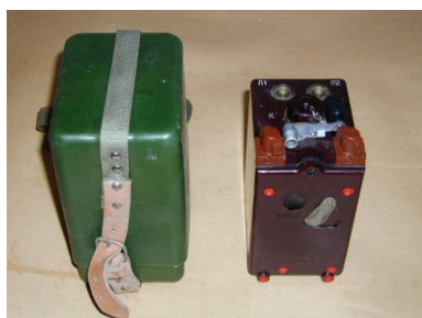
Конденсаторная подрывная машинка КПМ-3
